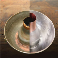
銅鍋 左修理前 右修理後
